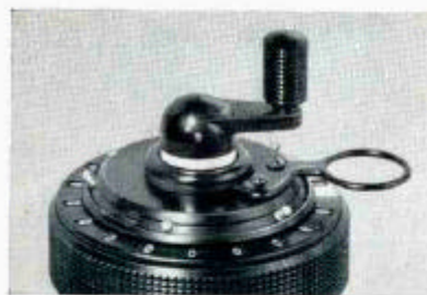
Fig. 5. La manivelle tirée en position de soustraction.
