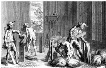
Stocké dans des magasins secs et aérés, le chanvre est travaillé dans l'atelier des *espadeurs* qui le débarrassent de la *chènevotte* encore attachée à la filasse.
