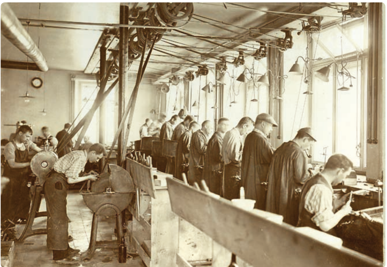
Ateliers d'horlogerie vers 1900, transmission par courroies.
