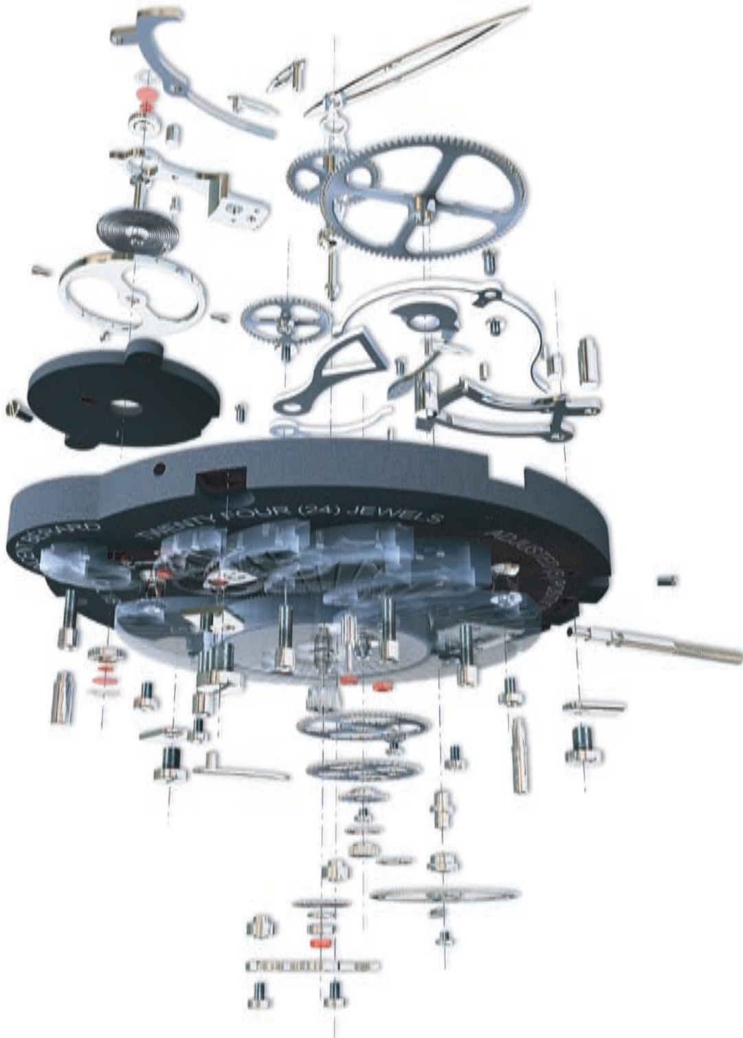
Cal. VB441. Eclaté de la cadrature et de la réserve de marche. Platine, ponts et rouage assemblés. © Vincent Bérard SA.
