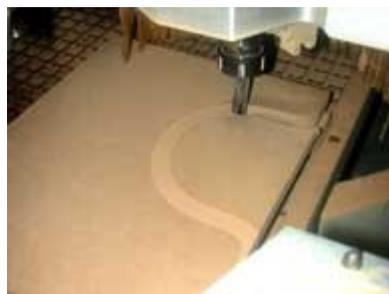
Usinage avec le renvoi d'angle (utilisation du 4ème axe).
